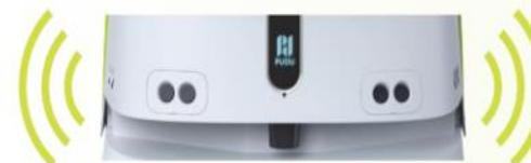
全方位に高感度センサーを配備し、障害物を効率よく回避します。また、回避されたルートは記憶され、AIによる清掃ルートの再設計が行われます。
