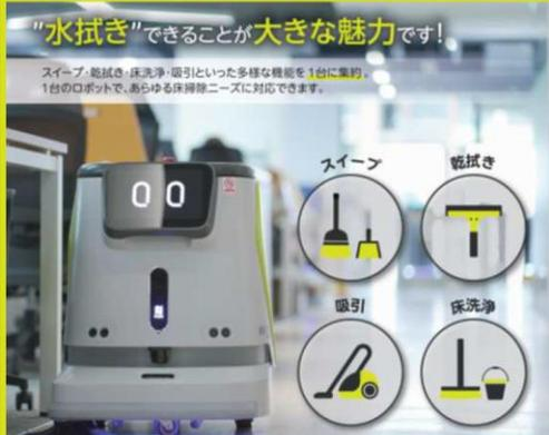
バッテリー残量10%まで低下すると、ロボットは自動的に充電スポットへと帰還します。ワークステーションがあれば、充電だけではなく、給水・排水も自動的に完了します。充電端子との接続、清水の補充、吸水した汚水の排水処理などで人の手をわずらわせません。
